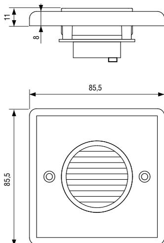
Новое компактное устройство BEDHEAD сирен серии SONORA позволяет встраивать его непосредственно в стену. Низкий уровень потребления энергии позволяет использовать его в охранных и пожарных системах.
