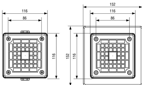
Серия GPH компактное устройство с выходом звукового сигнала до 110 дБ(А), конструкция устройства позволяет встраивать его непосредственно в стену. Надежная альтернатива твердотельным сигнализаторам. Низкий уровень потребления энергии и огнеупорный корпус обеспечивают широкий спектр применения.
