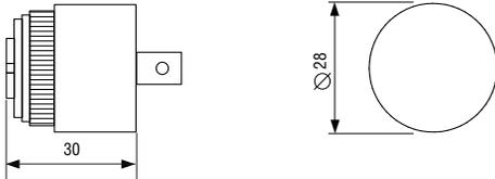
Звуковой индикатор E2S28D, предназначен для использования в шкафах и панелях управления. Класс защиты IP65 и низкое потребление тока обеспечивает непревзойденную надежность в экстремальных условиях.
