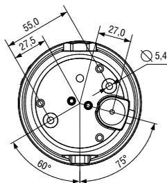
Светофор серии B350, доступны версии с патроном для лампочки E14 и с встроенной светодиодной матрицей. Компактный корпус идеален для применения в стеснённых условиях или непосредственно для установки на машины или другие объекты. Устройства спроектированы таким образом, чтобы имелась возможность соединять их совместно, создавая последовательность предупреждающих цветов.
